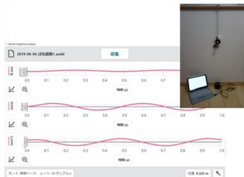
図3 センサーを用いた単振動の演示実験とそのグラフ
