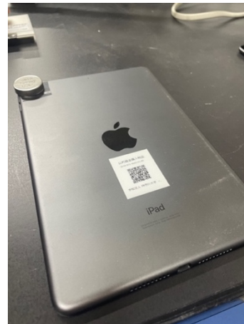
図7 そらまめアプリをインストールしたタブレットのカメラセンサー付近に放射線源 ^{90}\text{Sr} (ストロンチウム90) を置いて観測を行っている様子
